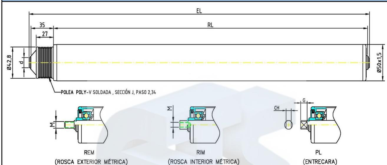
En esta serie podemos montar eje de Ø12, Ø14 y Ø15. Generalmente, estos rodillos se montan con rosca interior M-8 en los extremos del eje.
